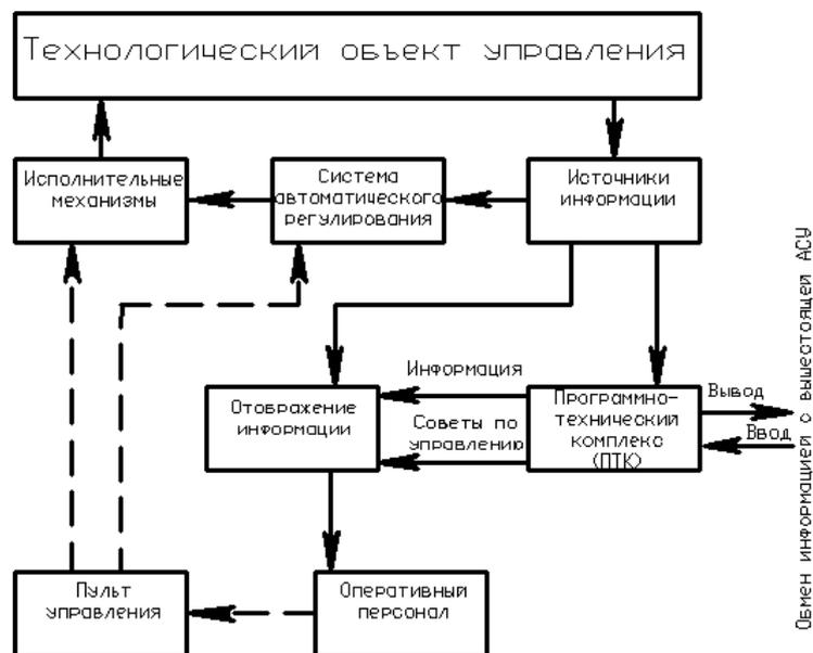
Рисунок 2.4 – Структура АСУТП, выполняющей информационные функции (в режиме «советчика»)
