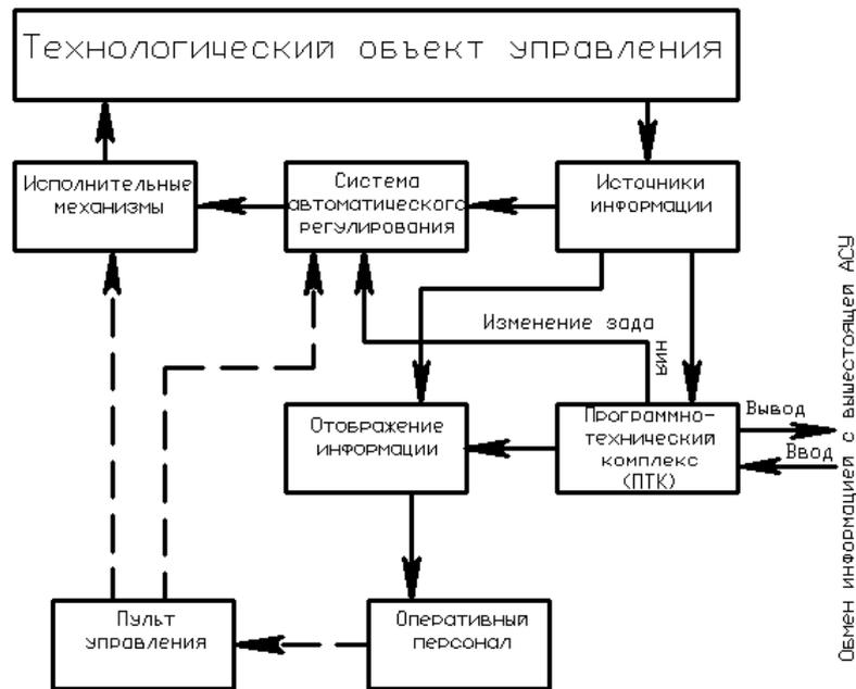
Рисунок 2.5 – Структура АСУТП, функционирующей в супервизорном режиме
